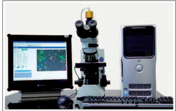
**Abbildung 1:** MedeaLAB CASA-System, bestehend aus Phasenkontrast-Mikroskop, OCTAX-Kamera, Computer und Software.
