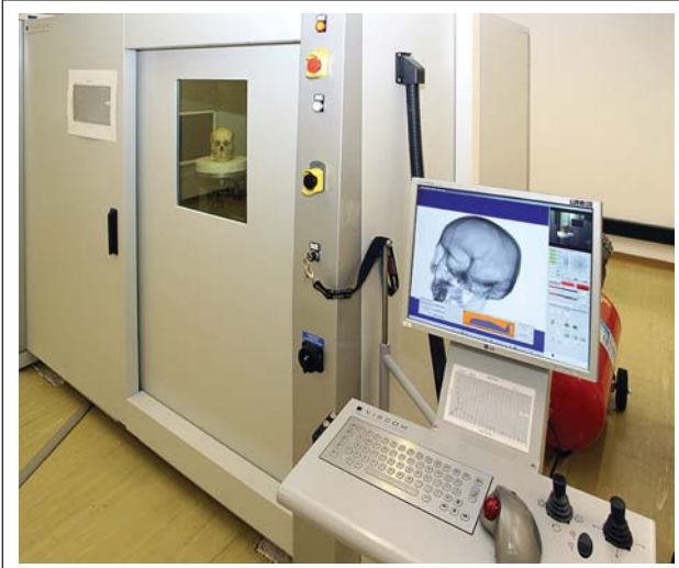
Abbildung 2: µ-Computertomograph (VISCOM X8060 II) am Department für Anthropologie der Universität Wien. Die Maschine kann Objekte in der Größe kompletter Schädel in sehr hoher Auflösung scannen.
