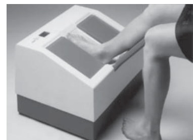
Abbildung 3: Demonstration der quantitativen Ultraschallmessung am Calcaneus im Wasserbad mit dem Lunar Achilles (Lunar Corp., Madison, Wisconsin, USA).
