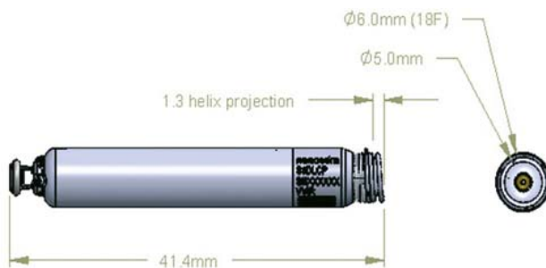
Abbildung 5: Abmessungen des Nanostim™
