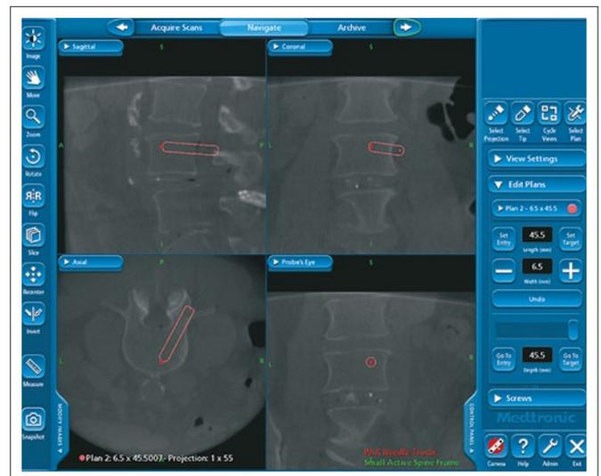
**Abbildung 6:** Durch Festlegen des Zielpunkts in unterschiedlichen Schnitten wird die Trajektorie durch den Pedikel angelegt.
