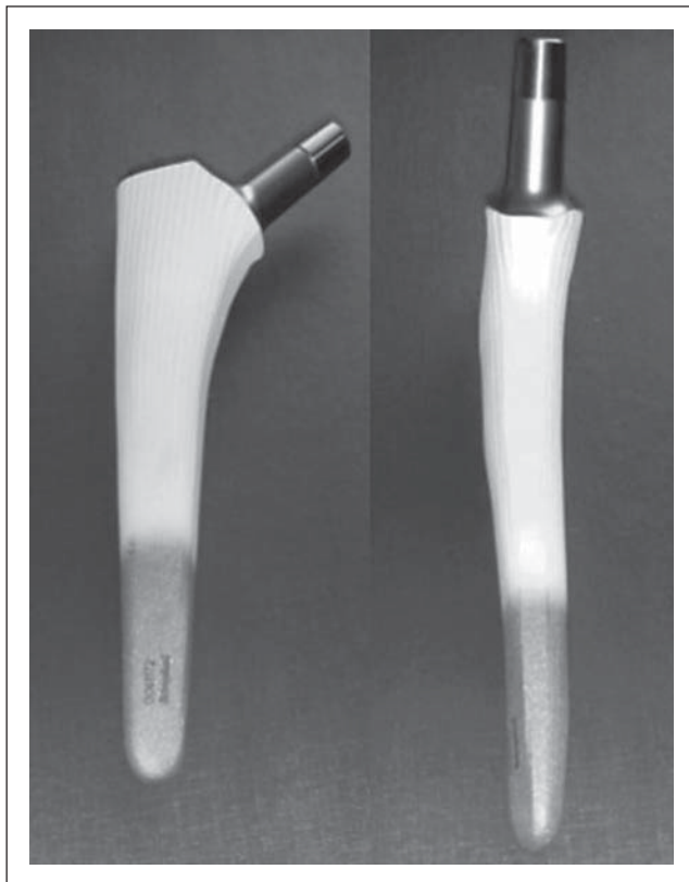
Abbildung 15: Hüftendoprothesenschaft Typ SBC. Anatomisch adaptierte Form des Schaftes mit Hydroxylapatitbeschichtung zur raschen Osteointegration.
