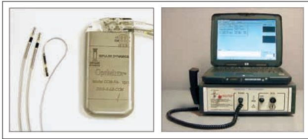
Abbildung 3: Links: implantierbarer Impulsgenerator, zwei RV-Elektroden und eine atriale Elektrode; rechts: Programmiergerät zur transkutanen Abfrage und Programmierung des implantierten Systems
