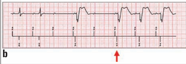
Abbildung 3a: MVP™-Grundfunktionen II – Ventrikuläres Back-up: Ventrikelstimulation nur bei Ausfall der AV-Überleitung; b: MVP™-Grundfunktionen III – DDD(R)-Switch: AV-sequentielle Stimulation mit optimiertem AV-Intervall nach 2 nicht geleiteten atrialen Ereignissen (Quelle: Medtronic)
