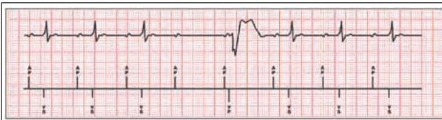
Abbildung 2: MVP™-Grundfunktionen I – AAI(R)-Mode: Atrial based Pacing erlaubt intrinsische AV-Überleitung; PR-Intervalle werden nur durch den eigenen Vorhof oder durch die Sensorfrequenz bestimmt, ein Ventrikel-Sensing (VS) vor dem nächsten AS oder AP ist ausreichend, um den AAIR-Modus zu erhalten (Quelle: Medtronic)
