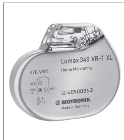
Abbildung 3: Lumax 340 VR-T XL; Einkammer ICD mit etwa 10 Jahren Laufzeit
