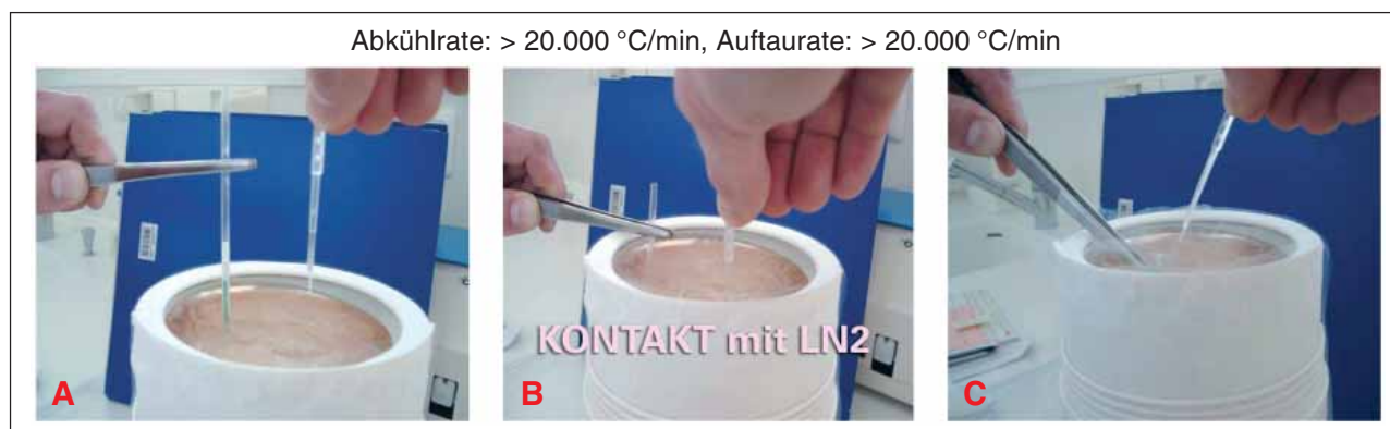
Abbildung 4: Ultra-schnelle Vitrifikation. A: Hemi-Straw + CBS-Straw, B: Einbringen des Hemi-Straw direkt in LN 2 , dadurch direkter Kontakt mit LN 2 , C: Hemi-Straw wird unter LN 2 in den CBS-Straw gegeben.
