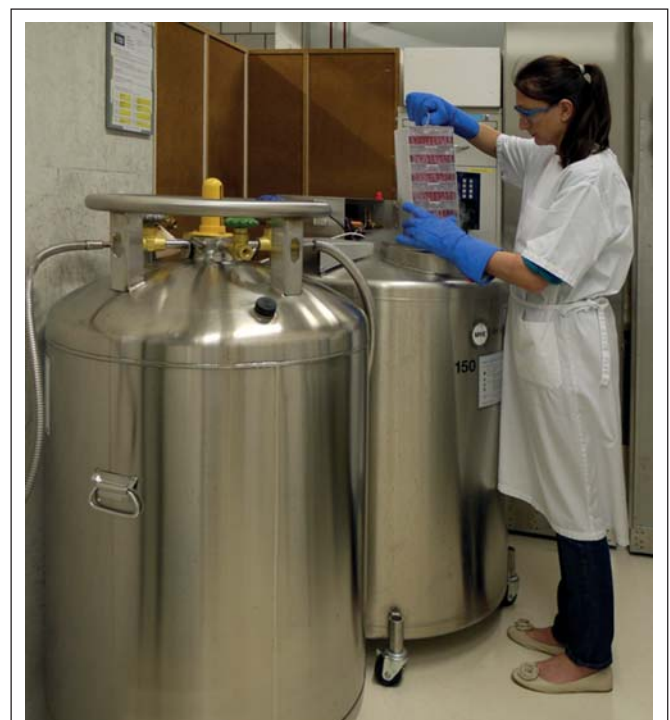
Abbildung 2: Anlage zur langfristigen Lagerung von Ovargewebe und Oozyten in der Gasphase flüssigen Stickstoffs (Universitäts-Frauenklinik Bern)
