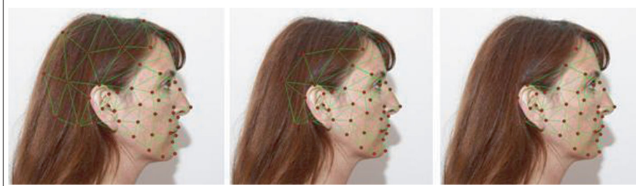
Abbildung 3: Die modifizierten Graphen für die Seitenansicht (links Standardgraph, Mitte nach dem ersten, rechts nach dem zweiten Optimierungsschritt).
