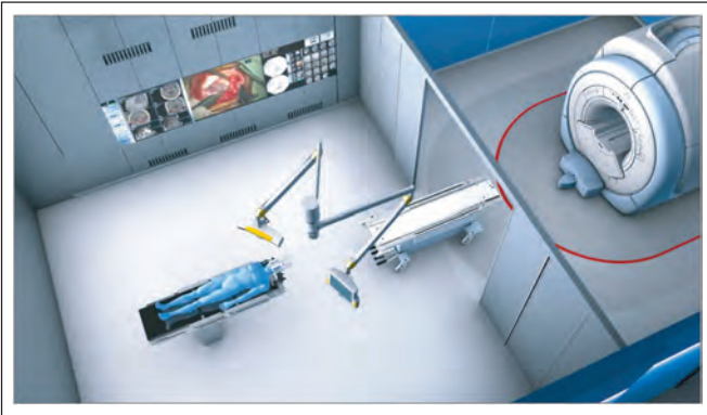
Abbildung 1: Zwei-Raum-Konzept mit unabhängig voneinander nutzbaren Räumen. Die 5-Gauß-Linie als Grenze für unbedenkliche Anwendung ferromagnetischer Gegenstände ohne Gefahr für magnetische Anziehung in den Magneten oder Artefaktentstehung befindet sich außerhalb des Operationssaales. Abdruck mit freundlicher Genehmigung von GE Healthcare.
