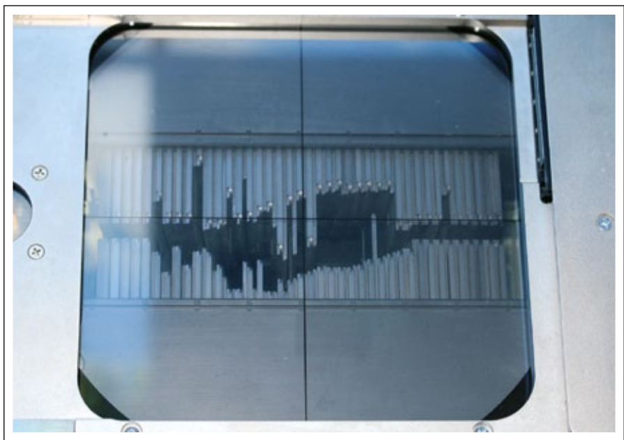
Abbildung 3: Multileaf-Collimator (MLC): optimale Anpassung der RT-Intensität. © Klinik für Radio-Onkologie, KSW
