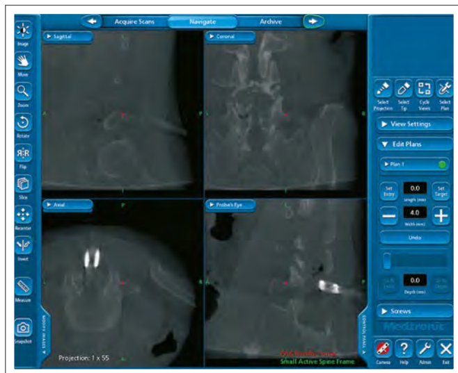
Abbildung 5: Der Eintrittspunkt am Pedikel (dunkelroter Punkt) wird in axialer, coronarer und sagittaler Ansicht definiert.
