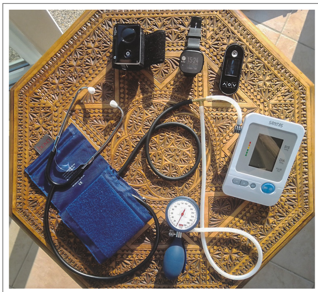
Abbildung 5: Die Messgeräte des Vergleichstests: obere Reihe von links nach rechts: Scala SC 8100 / Asus Vivowatch BP HC-A04 / Maiseense Freescan. Untere Reihe von links nach rechts: Manschette des Boso BS 90 mit angebautes Stethoskop / Gummiball-Pumpe und Manometer des Boso BS 90/T-Stück / oszillometrischer Messautomat Sanitas SBM 21.
