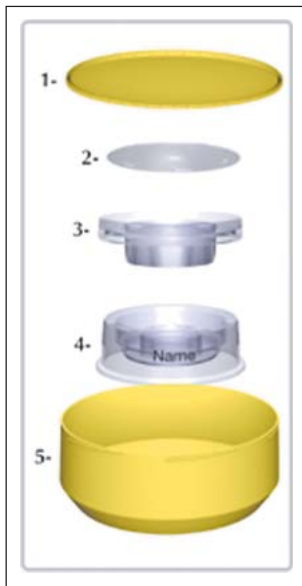
Abbildung 2: Der Zech-Selector® samt gelbem Transportcontainer. 1 = Deckel des Transportcontainers; 2 = Deckel des Zech-Selectors®; 3 = Kapillarsystem; 4 = Zech-Selector® bestehend aus einer äußeren und inneren Kammer; 5 = Transportcontainer.
