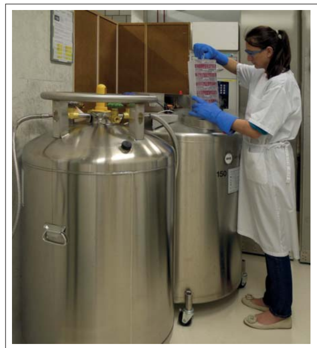
Abbildung 2: Anlage zur langfristigen Lagerung von Ovargewebe und Oozyten in der Gasphase flüssigen Stickstoffs (Universitäts-Frauenklinik Bern)
