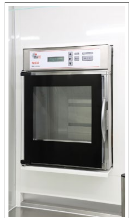
Abbildung 3: In die Rückwand integrierter Kleininkubator.
