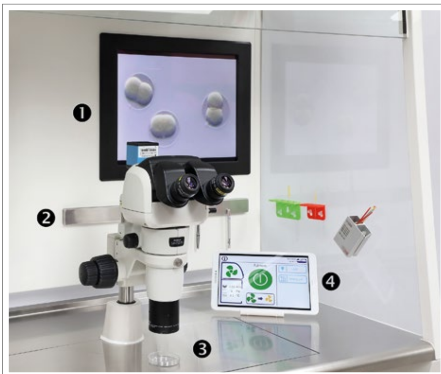
Abbildung 2: Detail des Arbeitsbereichs mit integriertem Monitor (1), magnetischem Werkzeughalter (2), Heizfläche (3) und CR2000 Smart Control, gespiegelt auf ein Tablet (4).
