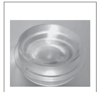
Abbildung 11b: Mit Hilfe von akustischen Linsen wird die ebene Welle in eine konvergente Kugelwelle transformiert und in der Therapiezone konzentriert.
