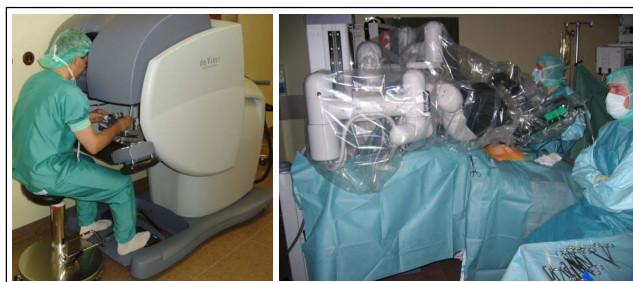
Abbildung 1: DaVinci-Teleanipulator mit ergonomischer Konsole (links) und präzisen Instrumentenarmen am Stativ, die die Freiheitsgrade einer Hand besitzen (rechts).
