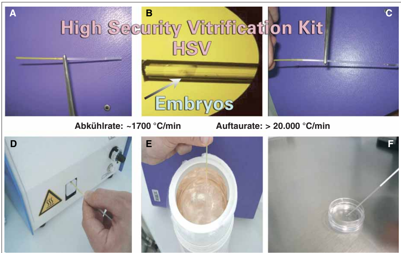
Abbildung 5a: Aseptische Vitrifikation mit dem High Security Vitrification Kit (HSV). A: Mini-Hemi-Straw, B: Mini-Hemi-Straw mit Tropfen inkl. 2 Embryonen, C: Mini-Hemi-Straw in 250 µl Straw eingebracht, D: Versiegeln von 250 µl Straw, E: Einbringen des versiegelten Straws in LN2, F: Einbringen der Spitze des Mini-Hemi-Straws, in eine Lösung von Succrose.
