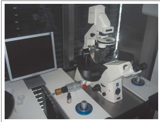
Abbildung 1: IMSI-Mikroskop auf schwingungsgedämpftem Tisch. Der seitliche Zoomadapter wird für die über 6000-fache Vergrößerung benötigt. Die Spermienmorphologie wird auf dem Monitor beurteilt.
